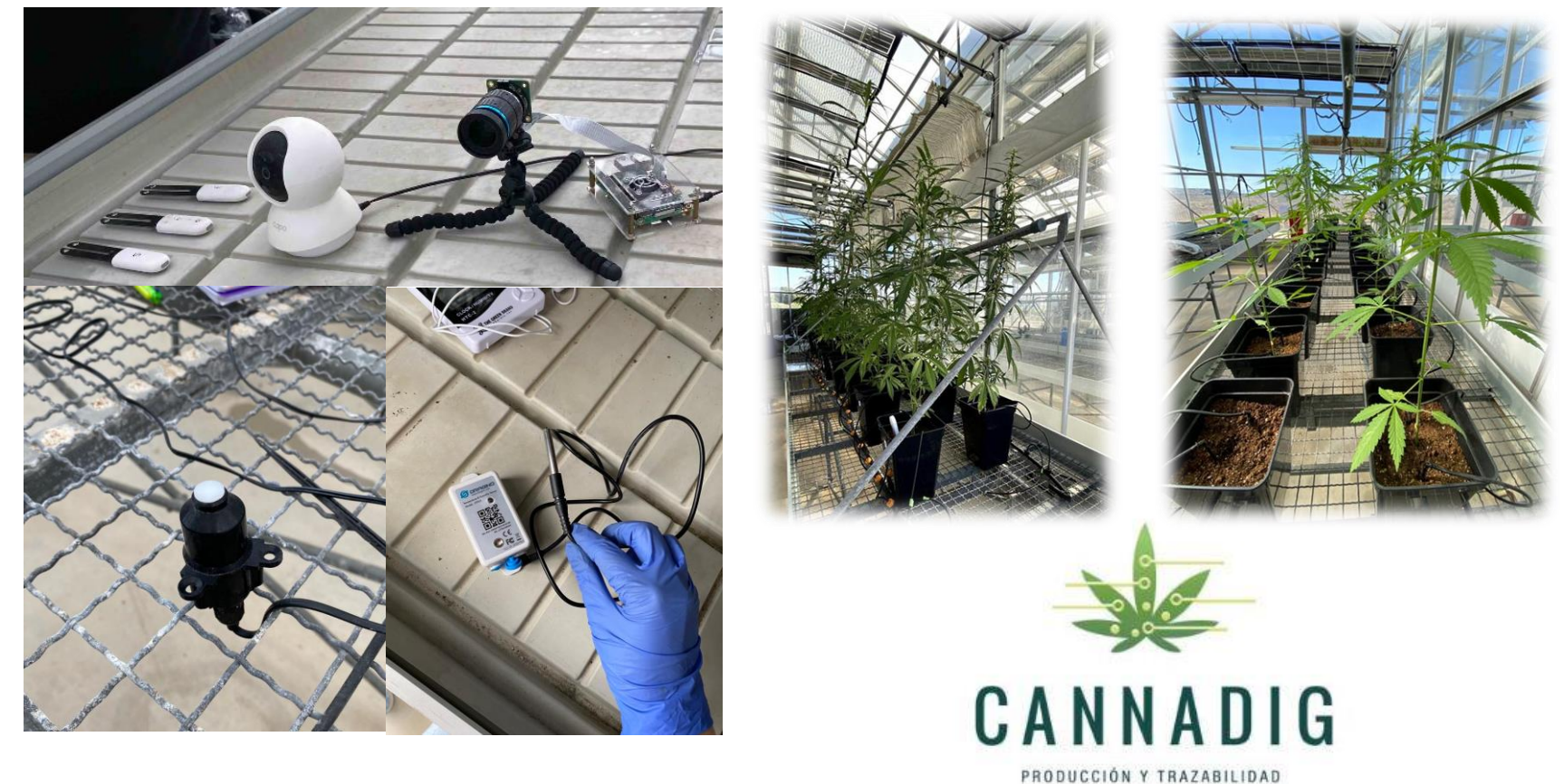
Figura 1. Sensores IoT para recopilación de datos ambientales y riego en maceta para el cultivo del cáñamo. Proyecto CANNADIG.
